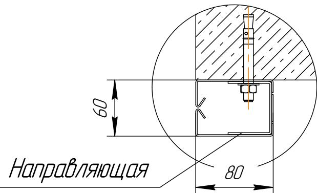
Вес шторы приходится на две боковые крышки, расположенные слева и справа. Для конструкций шире 3-х метров предусматривается установка дополнительных кронштейнов для обеспечения жесткости короба. Вес погонного метра короба составляет 30 кг, вес погонного метра направляющих шин 5 кг.
